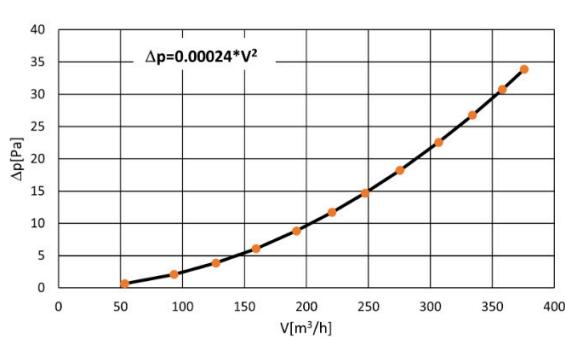
rys. 3. Charakterystyka hydrauliczna czerpiąca K1.
