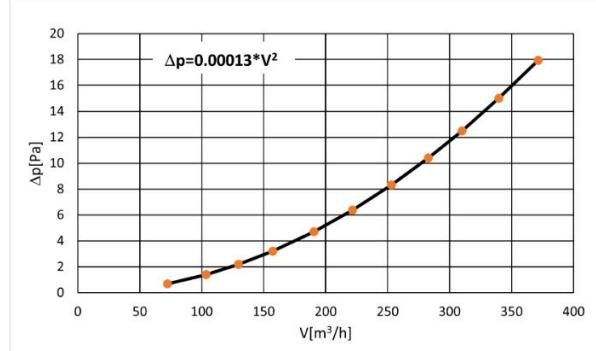
rys. 4. Charakterystyka hydrauliczna wyrzutni K1.
